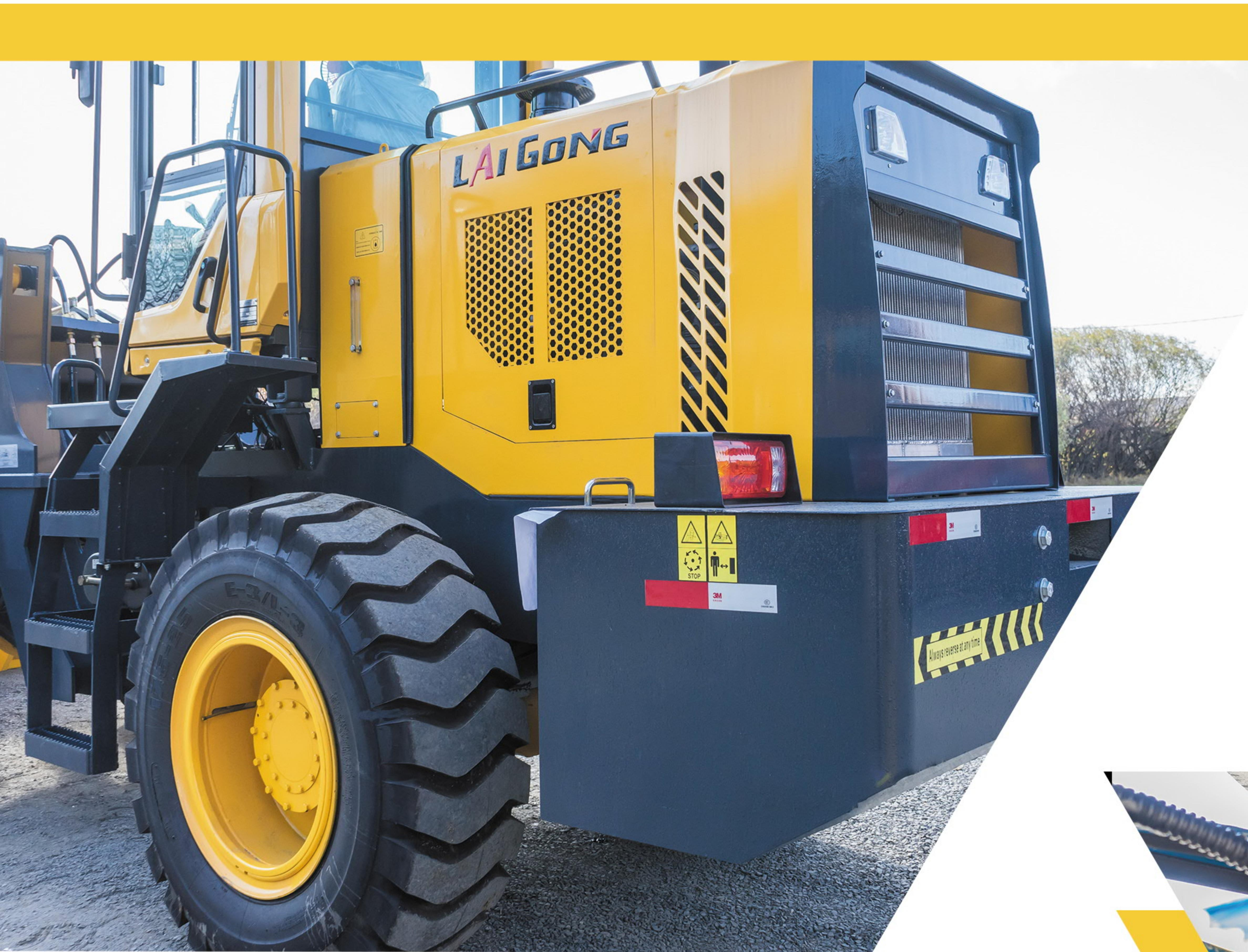
Большой противовес обеспечивает хорошую устойчивость погрузчика при движении на неровной поверхности с полной загрузкой ковша.
